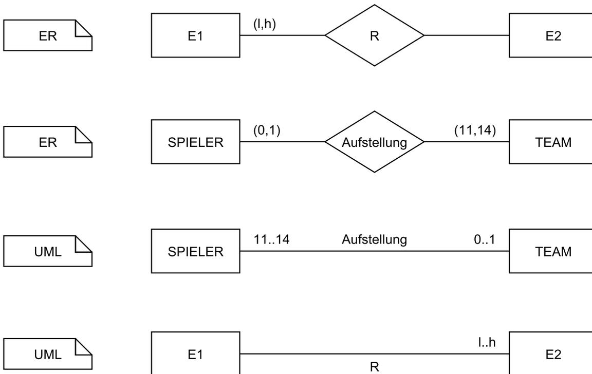
Entity vom Typ E1 steht mittels R mit mindestens l und höchstens h Entities vom Typ E2 in Verbindung; Constraint für Verbindungsfähigkeit
